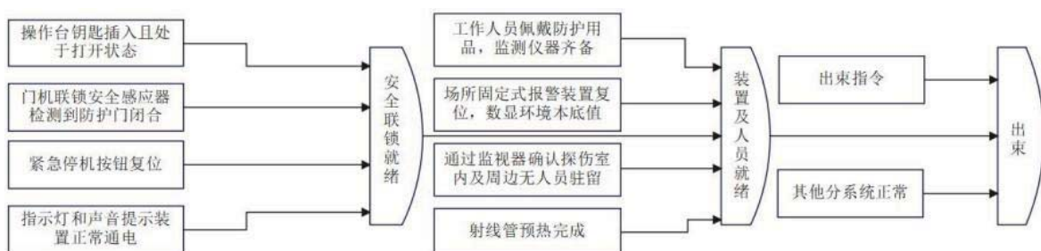
图 10-7 辐射安全联锁装置逻辑关系图
