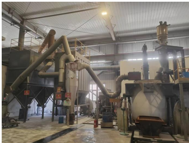
图 4.1-3 熔炼废气收集及治理装置现场图
