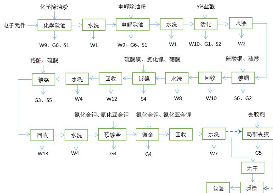
图 4.6-13 镀金生产线工艺流程及排污节点图
