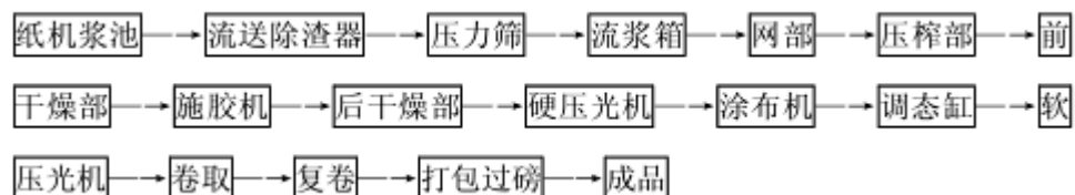
图 2.6-13 造纸工序工艺流程
