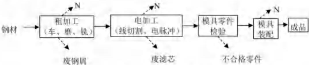
图2.3-1 模具制造生产工艺及产污节点图
