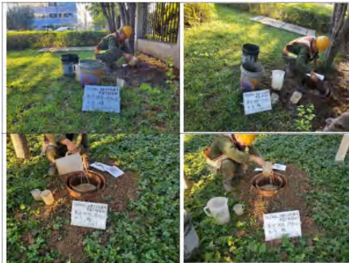
图 4.3-11 现场渗水试验照片
