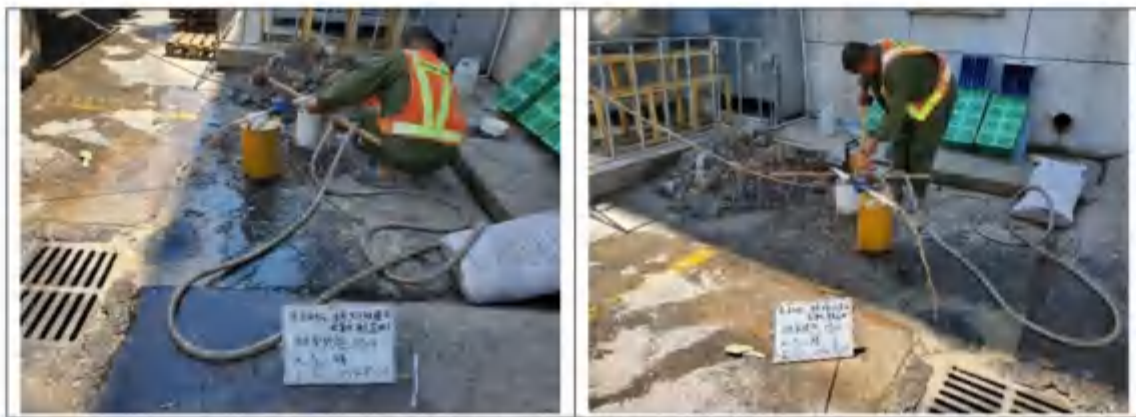
图 4.3-6 抽水试验现场照片
