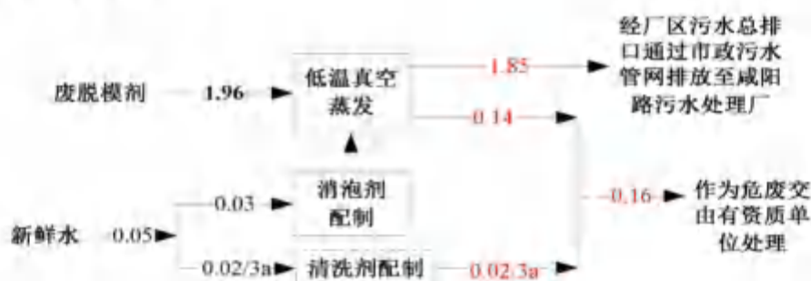
图 3.5-1 本项目水平衡图（单位： \text{m}^3/\text{d} ）
