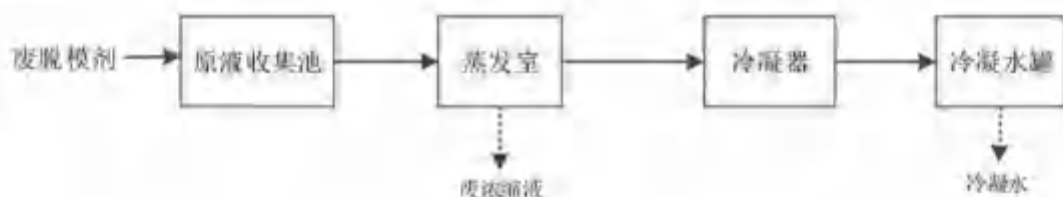
图 3.6-1 本项目固体废物减量化总体处理工艺流程及产污环节图
