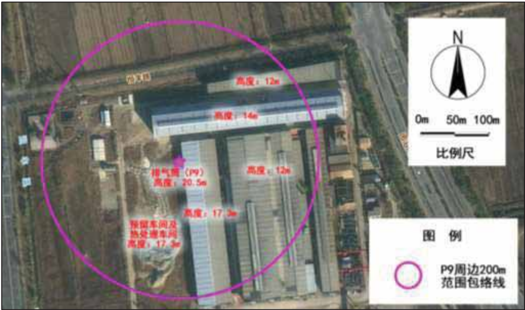
图 3-1 排气筒与周边建筑高度对比图
